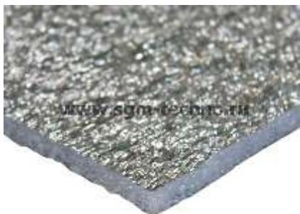
Бюджетный теплозвукоизоляционный материал на основе несшитого (газовспененного) пенополиэтилена (НПЭ). Материал имеет клеевой монтажный слой высокой адгезии и улучшенной липкости, защищенный силиконизированной пленкой. С лицевой стороны может присутствовать лавсановая металлизированная пленка или алюминиевая фольга.
